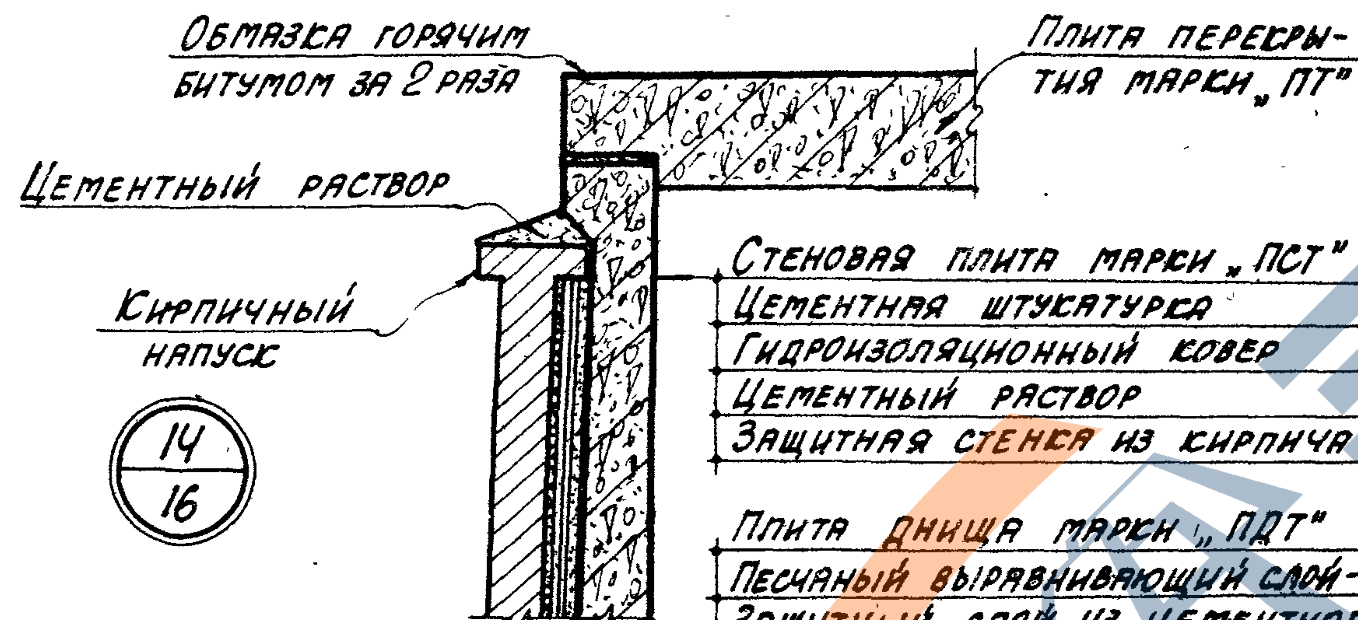
ПОПЕРЕЧНЫЙ РАЗРЕЗ ТОННЕЛЯ С ОКЛЕЕЧНОЙ ГИДРОИЗОЛЯЦИЕЙ
